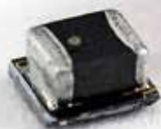
Den lille effektkonverter fylder kun 2,0 x 2,2 mm.
